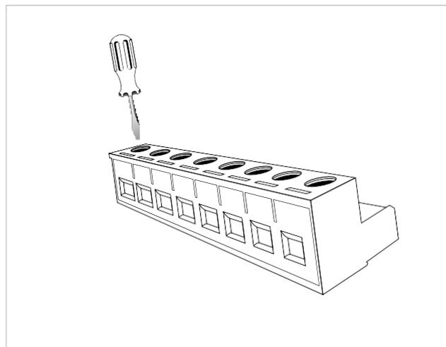
Fig. 2-3 Aflojando los tornillos de la terminal
