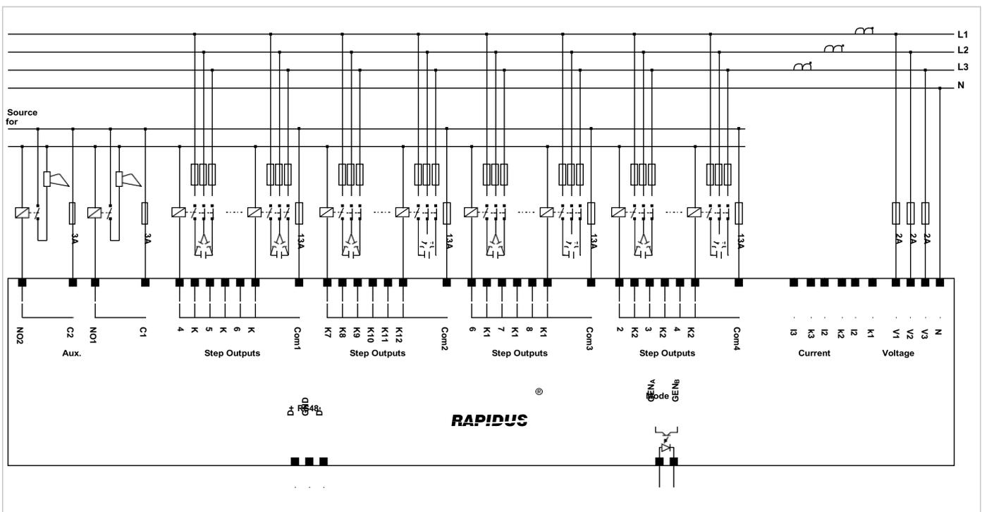
Fig. 2-7 Diagrama de conexión Rapidus (24 Steps)
