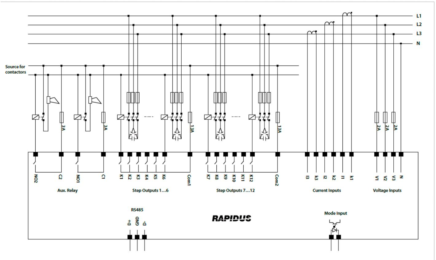
Fig. 2-6 Diagrama de conexión RAPIDUS (12 Steps)
