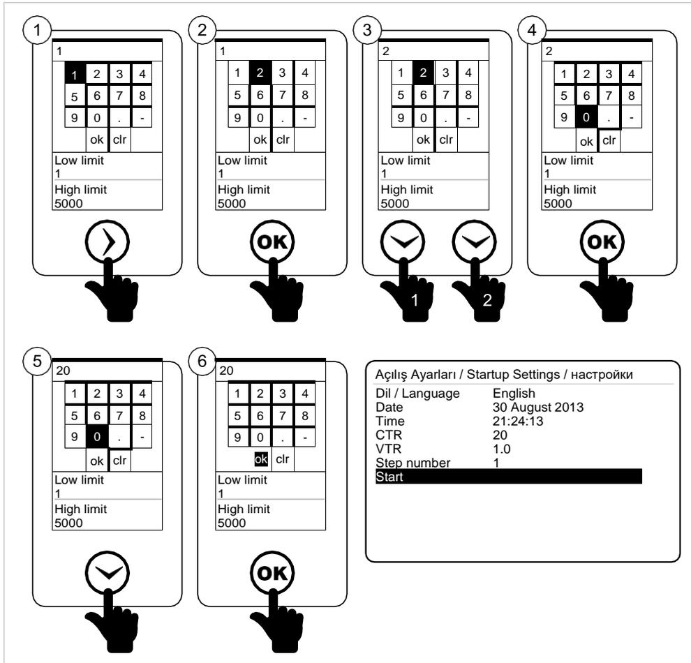
Fig. 3-6 Ingresando un Valor en el Teclado Virtual
