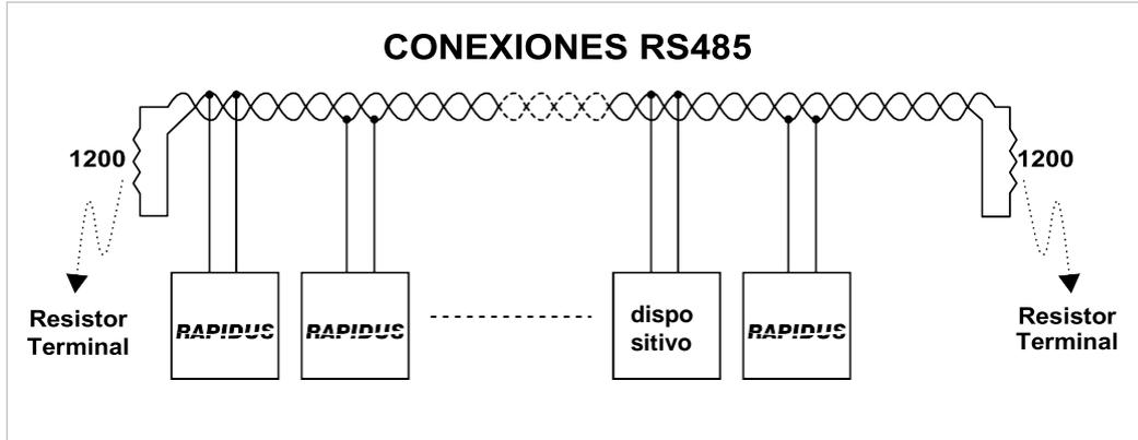
Figure 4-1 Diagrama de Conexiones RS485
